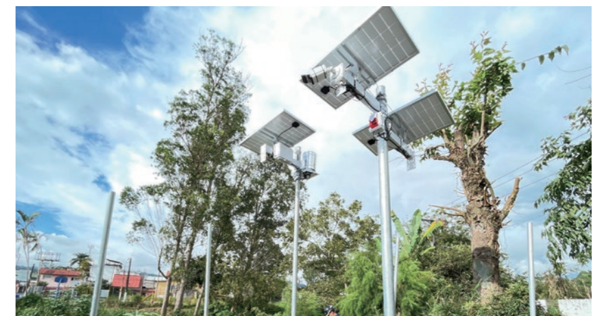
瓜地馬拉水情 AIoT 智慧聯網自動化觀測站
