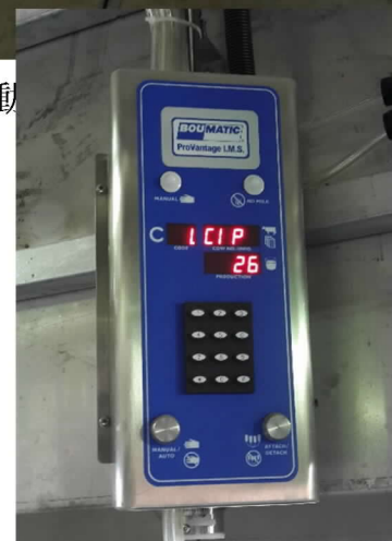
自動擠乳設備裝置的 自動流量紀錄儀
