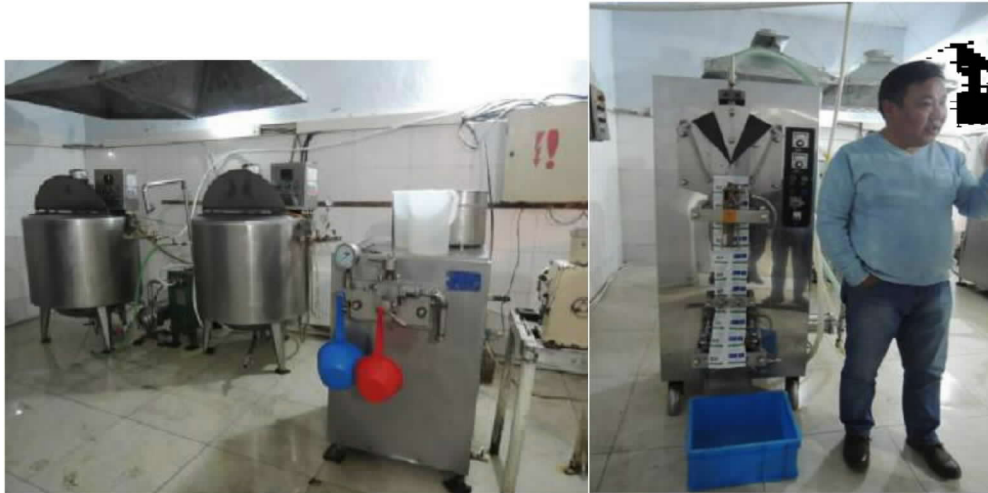
地下室有殺菌、包裝設備，有自己的廠牌；右圖為會長與塑料包裝機。
