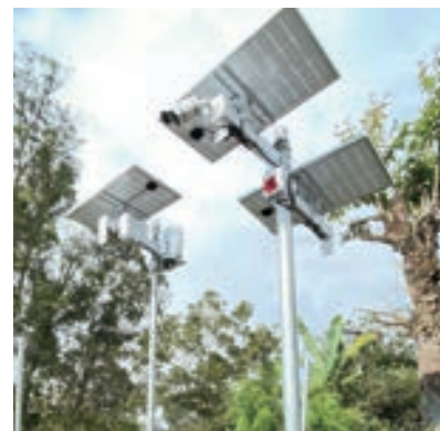
Estación de observación AloT automatizadas para la detección de datos hidrológicos en Guatemala.
